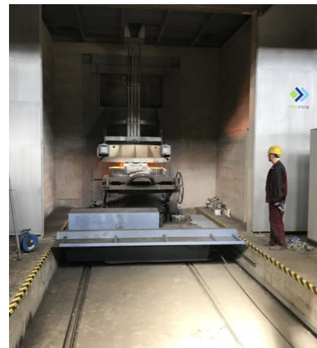
Zavázení pánve do modifikační kabiny
