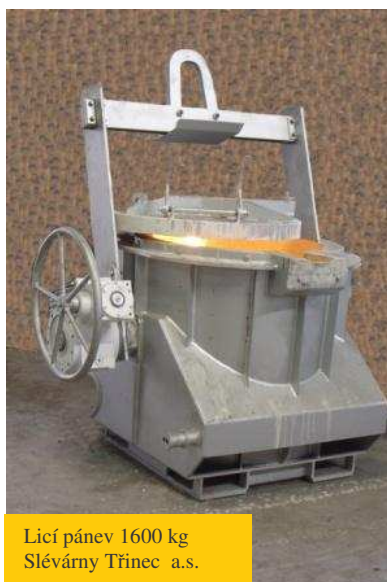
Modifikační pánev 1600 kg Slévárny Třinec a.s.
